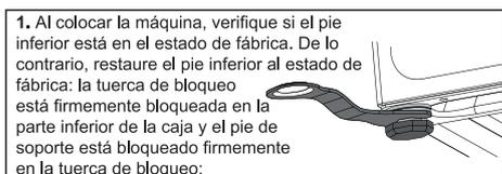
1. Al colocar la máquina, verifique si el pie inferior está en el estado de fábrica. De lo contrario, restaure el pie inferior al estado de fábrica: la tuerca de bloqueo está firmemente bloqueada en la parte inferior de la caja y el pie de soporte está bloqueado firmemente en la tuerca de bloqueo:
