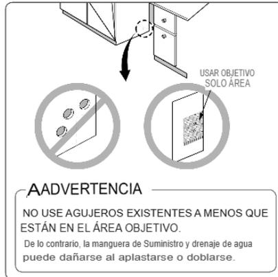
Es posible que se necesite una abertura en ambos lados para la plomería de la ruta y conexiones eléctricas.
